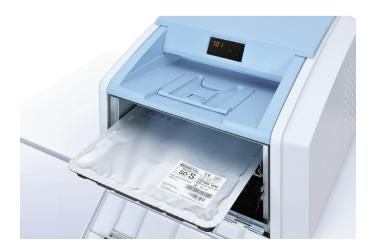
La película de impresión laser SD-S es una película de alta resolución, sensible a infrarrojos y fototérmica diseñada específicamente para las impresoras láser DRYPRO Sigma.
